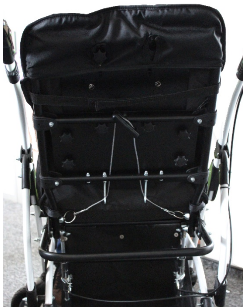
Ryc. 29B. Mechanizm regulacji kąta siedziska w wózku Junior Plus XXL
