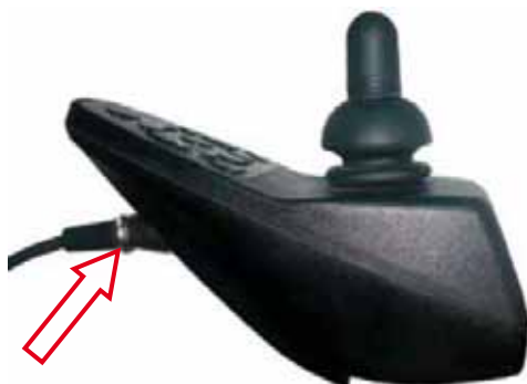
Ładowarka podłączona do gniazda w panelu sterowania
