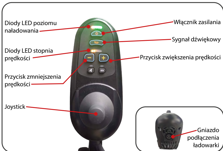
Ilustracja 3. Panel sterujący (joystick)
