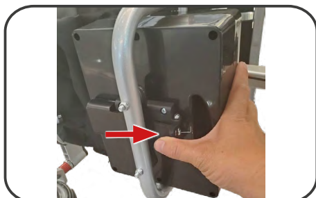
Ilustracja 9. Montaż i demontaż akumulatora.
