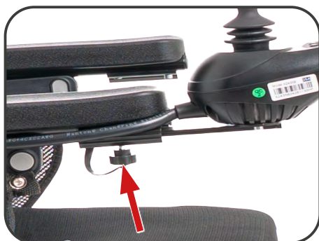
Ilustracja 12. Śruba regulacji panelu sterowania.
