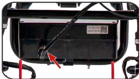
Ilustracja 8. Wpięcie złącza zasilania akumulatorów.
