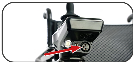
Ilustracja 16. Połączenie ładowarki do kontrolera.
