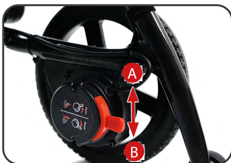
Ilustracja 13. Rozłączenie napędu silnika.
