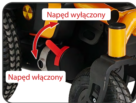
Ilustracja 4. Umiejscowienie dźwigni rozłączającej napęd.
