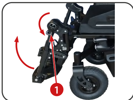
Ilustracja 16. Regulacja kąta pochylenia podnóżków.
