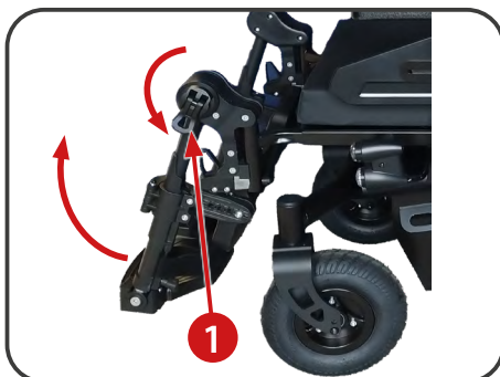
Ilustracja 22. Regulacja kąta pochylenia podnóżków.
