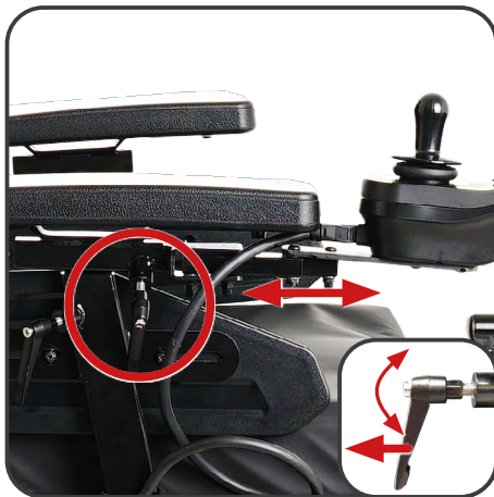
Ilustracja 11. Regulacja położenia panelu sterowania.
