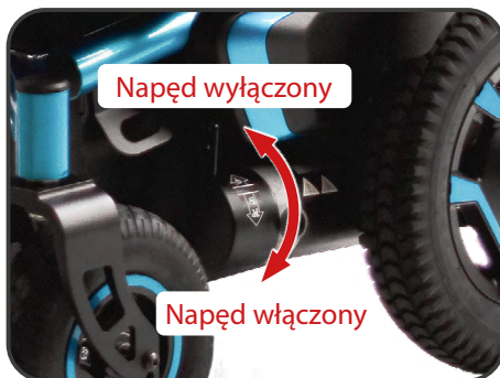
Ilustracja 4. Umieszczenie dźwigni rozłączającej napęd.
