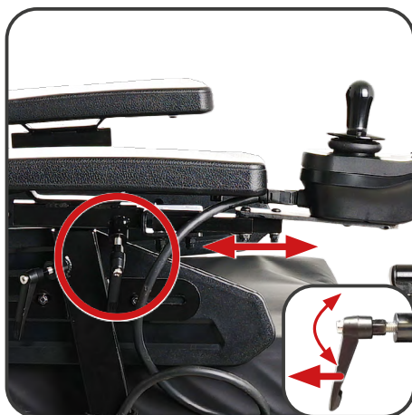
Ilustracja 8. Regulacja położenia panelu sterowania.
