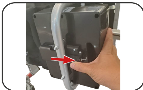
Ilustracja 9. Montaż i demontaż akumulatora.
