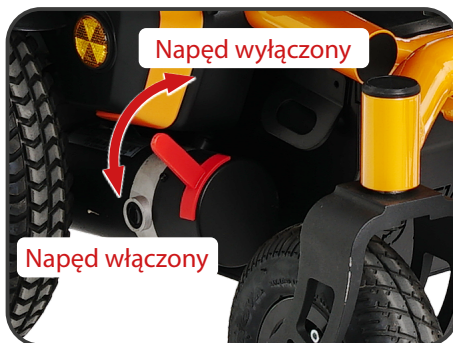
Ilustracja 4. Umieszczenie dźwigni rozłączającej napęd.
