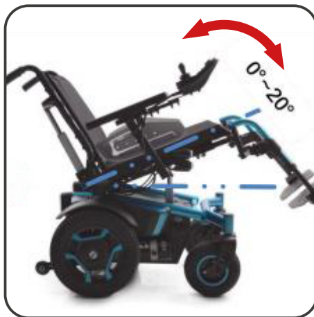
Ilustracja 10. Regulacja kąta pochylenia siedziska z oparciem.
