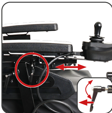
Ilustracja 11. Regulacja położenia panelu sterowania.
