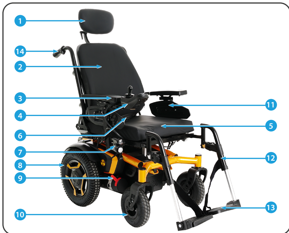
Ilustracja 1. Wykaz elementów wózka STAR model Orange - front.
