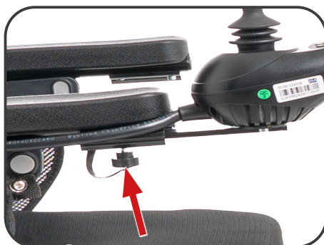
Ilustracja 12. Śruba regulacji panelu sterowania.
