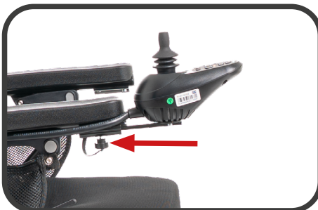
Ilustracja 4. Instalacja kontrolera.
