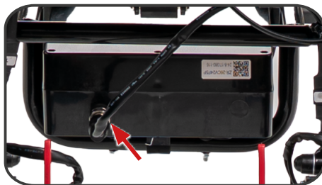
Ilustracja 8. Wpięcie złącza zasilania akumulatorów.
