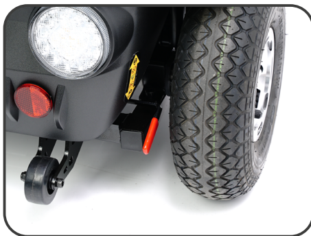
Ilustracja 3. Umiejscowienie dźwigni rozłączającej napęd.
