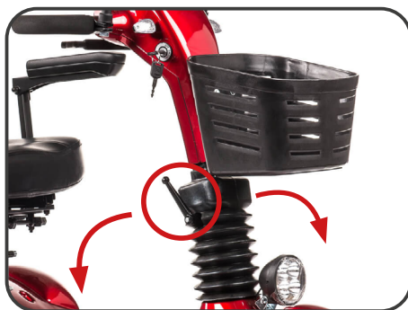
Ilustracja 3. Regulacja kąta nachylenia kolumny kierownicy.
