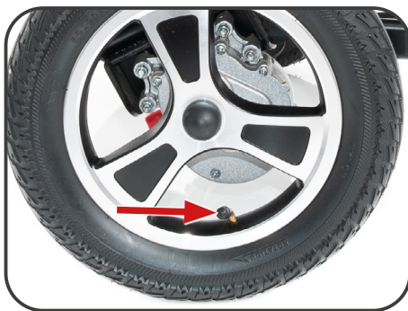
Ilustracja 18. Zawór „Schradera” (samochodowy)
