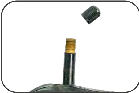
Illustration 27. „Schrader“ valve (automotive)
