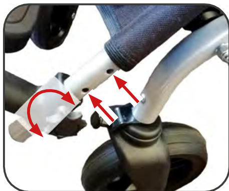
Illustrazione 16. Regolazione della pedana
