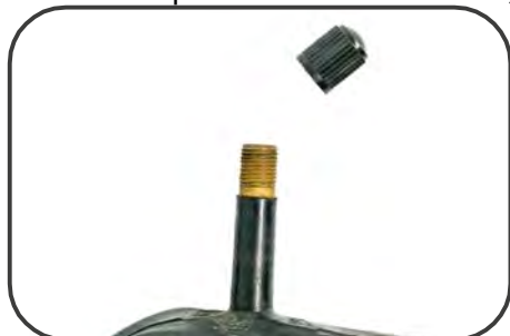
Illustrazione 27. Valvola “Schrader” (automobilistica)
