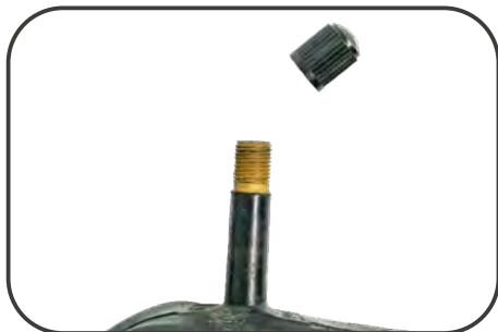
Ilustracja 27. Zawór „Schradera” (samochodowy)
