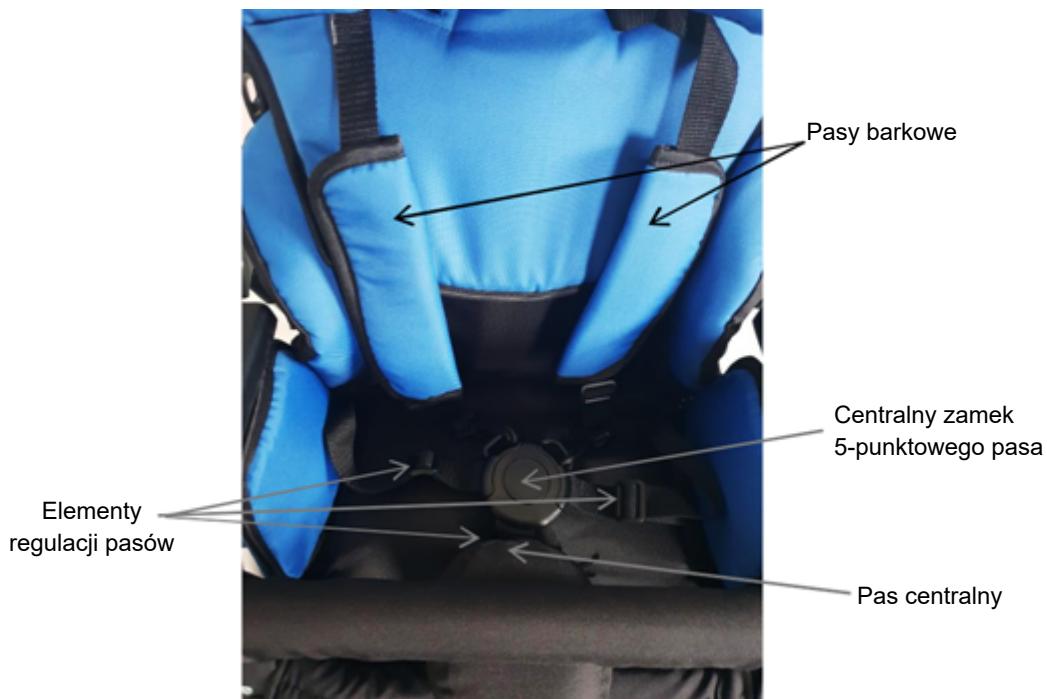
Ryc 28A. 5-punktowy system pasów
