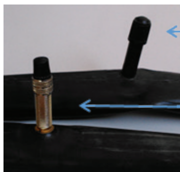
Ryc. 34. Zawory zakręcone
