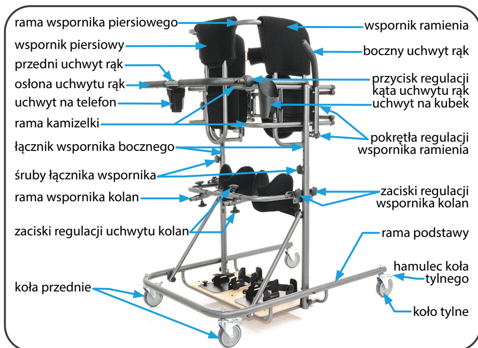
Ilustracja 1. Lista elementów - front parapodium.
