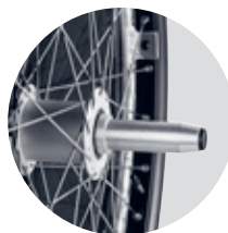
Specjalny model szybkozłączek dla stabilności kół nawet przy dużym kącie ich nachylenia
