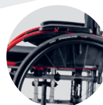
boczek z regulowanym wysokością podłokietnikiem, obsługa jedną ręką (opcja)
