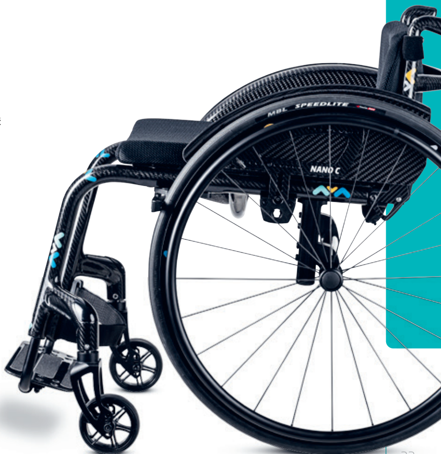
Rama monocoque: wykonana z jednego elementu, zapewniająca bardzo wysoką sztywność
