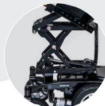
Elektryczny kąt siedziska z opcjonalnym podnośnikiem noży- cowym 300 mm
