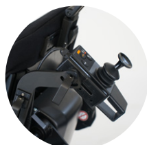
Nowo opracowany wspornik dla sterowania przez opiekuna (opcjonalnie)
