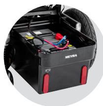
Łatwa konserwacja akumulatorów dzięki wysuwanej kasecie na akumulatory
