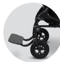
Składana platforma podnóżka
