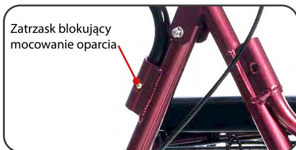
Ilustracja 9. Blokada mocowania oparcia.
