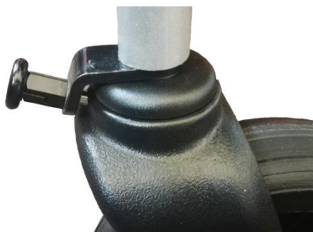
Ryc. 23. Blokada ruchu skrętnego kół
