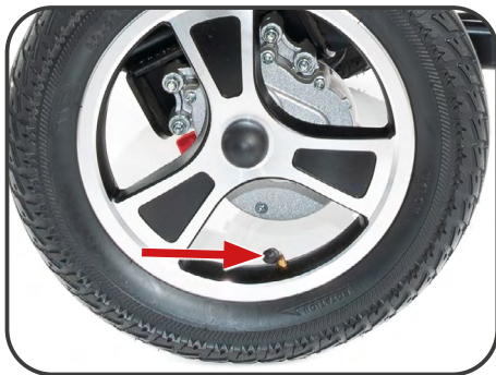
Ilustracja 29. Zawór „Schradera” (samochodowy)
