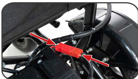
Ilustracja 7. Wpięcie złącza zasilania akumulatorów.
