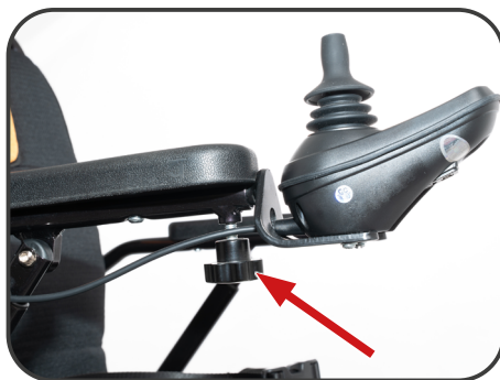
Ilustracja 9. Śruba regulacji panelu sterowania.
