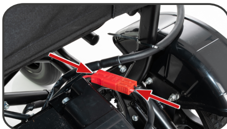
Ilustracja 6. Wpięcie złącza zasilania akumulatorów.
