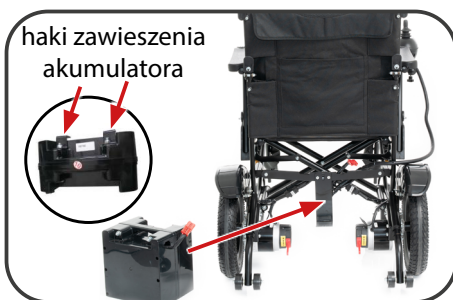
Ilustracja 4. Instalacja akumulatora.
