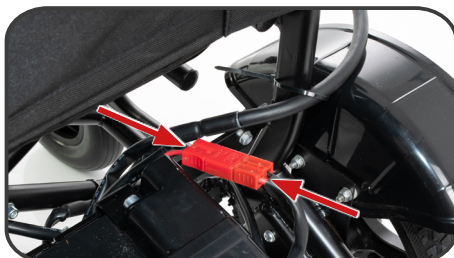
Ilustracja 6. Wpięcie złącza zasilania akumulatorów.
