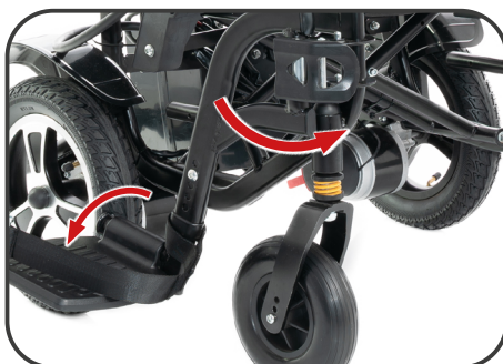
Ilustracja 9. Montaż podnóżka.
