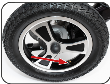
Ilustracja 22. Zawór „Schradera” (samochodowy)
