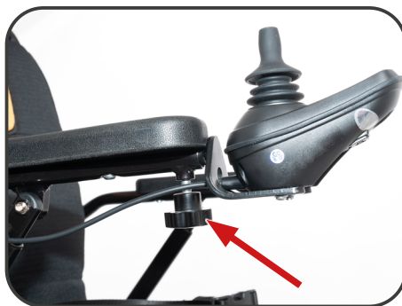
Ilustracja 9. Śruba regulacji panelu sterowania.
