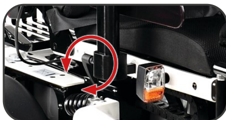
Ilustracja 5. Montaż i regulacja wysokości podłokietników.
