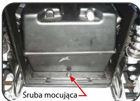
Ilustracja 4. Instalacja akumulatora.
