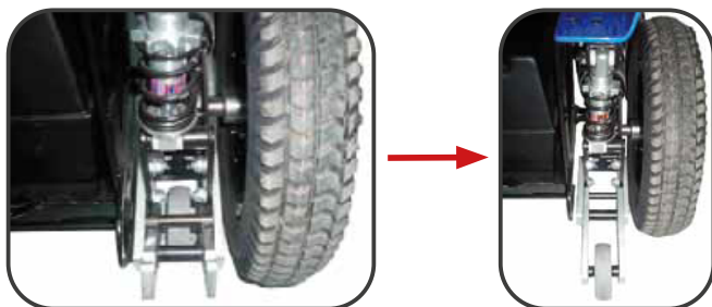
Ilustracja 9. Rozkładanie kółek antywywrotnych.
