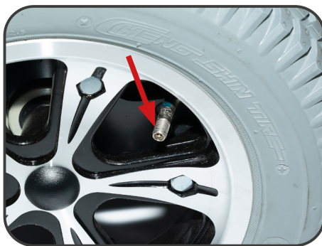
Ilustracja 19. Zawór „Schradera” (samochodowy)
